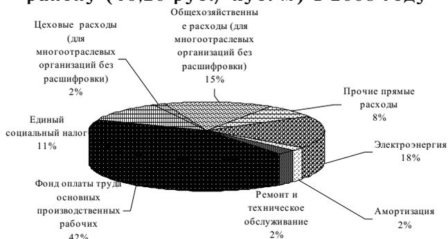
Наибольший удельный вес в структуре затрат по водоотведению занимают расходы на оплату труда основных производственных рабочих (42,0%). Весомыми расходами являются
