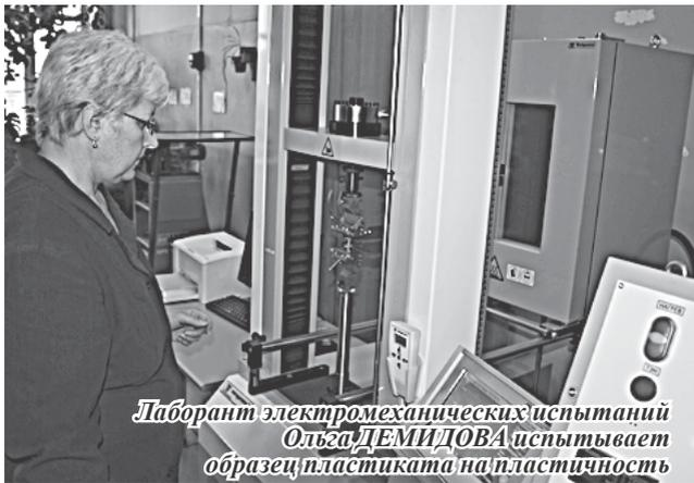
Лаборант электромеханических испытаний **Ольга ДЕМИДОВА** испытывает образец пластиката на пластичность
